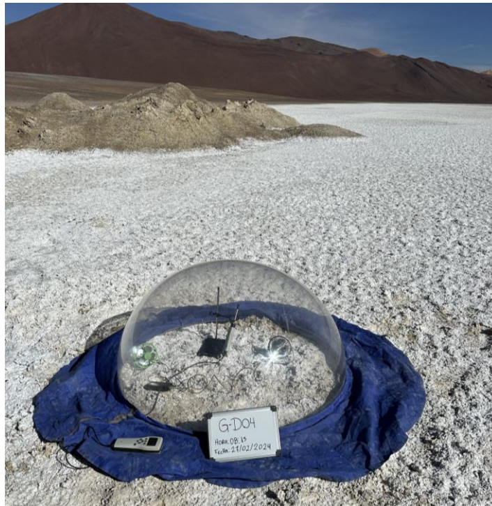
Figura 3-3: Ensayo de evaporación en domo del punto G-D04 ubicado en el salar de Gorbea.
