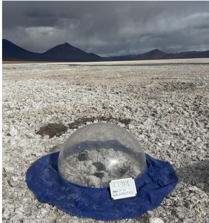
Figura 3-4: Ensayo de evaporación en domo del punto LI-D01 ubicado en el salar de La Isla.
