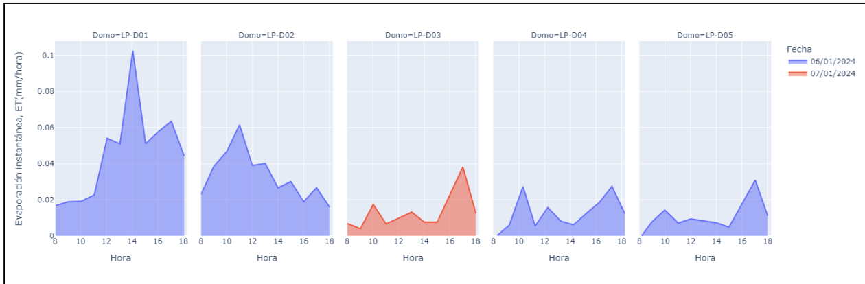
Figura 5-4: Series diarias de ensayos de evaporación de domos en el salar de Las Parinas.
