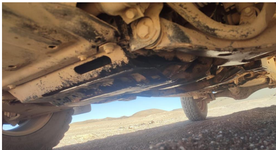
Figura 6-2: Fuga de líquido del sistema hidráulico en camioneta.
