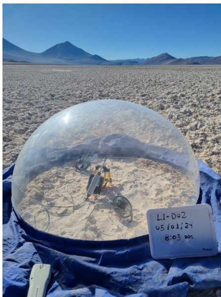
Figura 3-7: Ensayo de evaporación en domo correspondiente al punto LI-D02 ubicado en el Salar La Isla.
