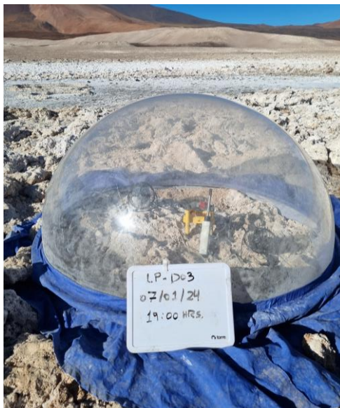
Figura 3-9: Ensayo de evaporación en domo correspondiente al punto LP-D03 ubicado en el salar de Las Parinas.
