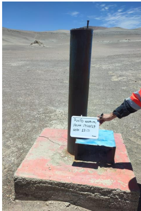
Figura 3-5: Monitoreo hidroquímico en punto de agua subterráneo GOR-M4 en el salar de Gorbea.
